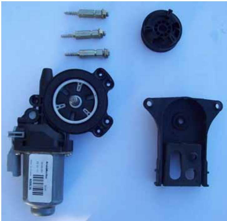
Le moteur, les trois vis de fixations, la poulie et le carter (en plastique) Et 2 câbles type frein de vélo, leur gaine et pièce terminale
